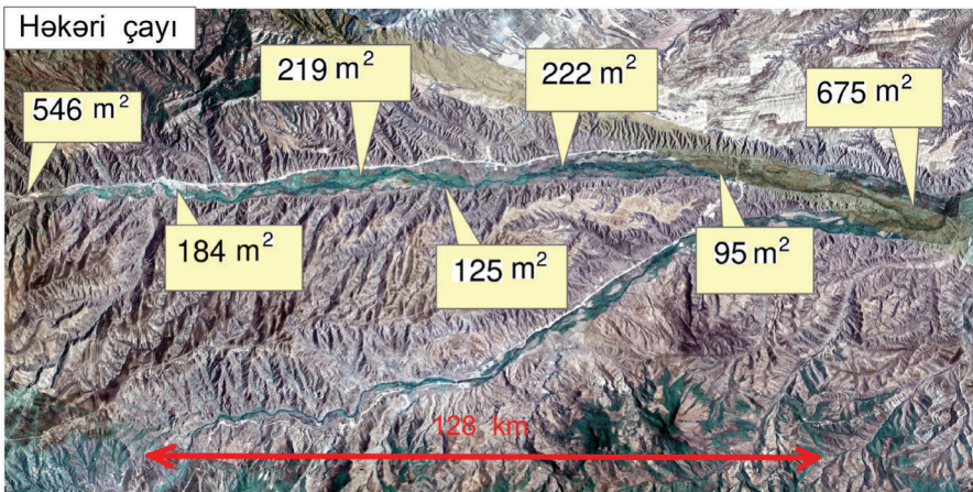
Şəkil 2. Həkəri çayının yataq sıxlıqlarının ölçüləri (12.06.2021 Landsat 8 OLI peykindən alınmış təsvir)
